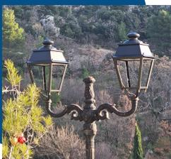
Le Conseil Municipal avait la volonté de préserver la faune nocturne et de réduire la pollution lumineuse. Le SEV a donc réhabilité l'ensemble électrique public en changeant les ampoules à filament pour des leds. Il en ressort un éclairage plus discret sur les habitations et une économie de 80% sur les factures énergétiques.
